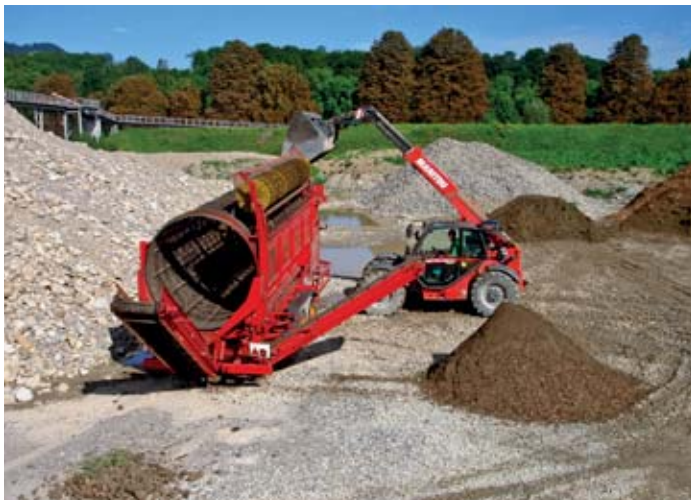
Gerührt und geschüttelt: In dieser Siebtrommel-Mischanlage wird die Humusmischung hergestellt, auf der später das Friedhofgrün wächst. Bild: Erich Aeschlimann
